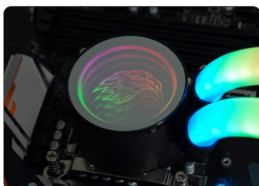
BOMBA FIXADA EM PLACA-MÃE
