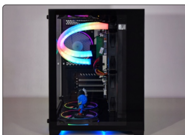
RADIADOR FIXADO EM GABINETE
