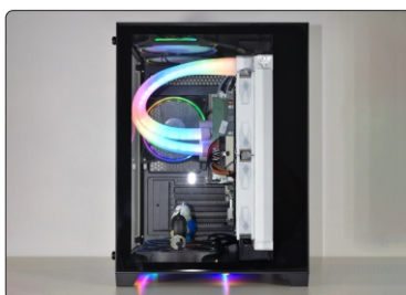
RADIADOR FIXADO EM GABINETE
