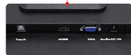
Entradas USB tipo B (p/ funcionamento do touch), HDMI, VGA e Fonte
