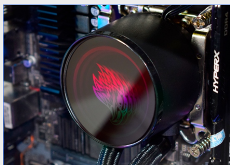
BOMBA FIXADA NA PLACA-MÃE
