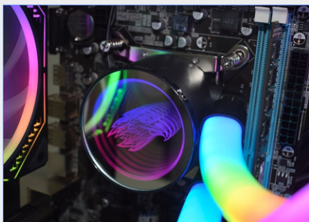
BOMBA FIXADA NA PLACA-MÃE
