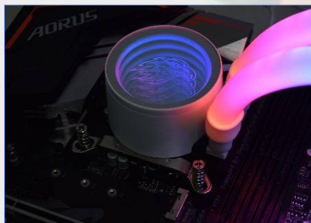
BOMBA FIXADA NA PLACA-MÃE
