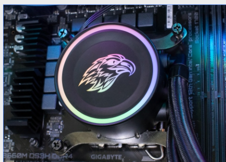
BOMBA FIXADA NA PLACA-MÃE
