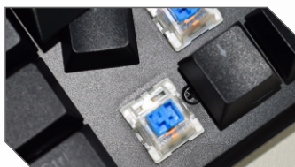
SWITCH BLUE (MAIOR PRECISÃO E RESPOSTA RÁPIDA)
