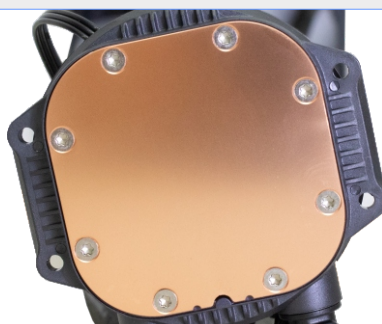
PLACA DE BASE DE COBRE (MAIOR CONDUTIVIDADE TÉRMICA)
