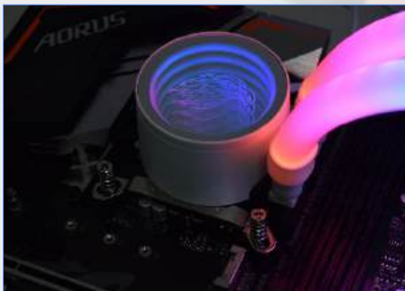
BOMBA FIXADA NA PLACA-MÃE
