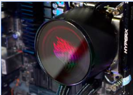
BOMBA FIXADA NA PLACA-MÃE
