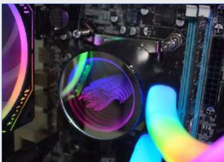
BOMBA FIXADA NA PLACA-MÃE
