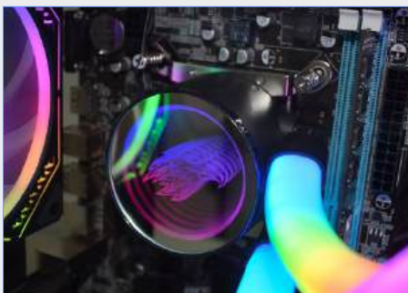
BOMBA FIXADA NA PLACA-MÃE
