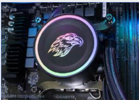
BOMBA FIXADA NA PLACA-MÃE
