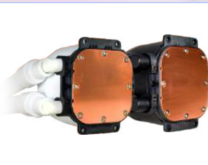
PLACA DE BASE DE COBRE (MAIOR CONDUTIVIDADE TÉRMICA)
