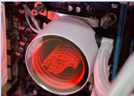
BOMBA FIXADA NA PLACA-MÃE
