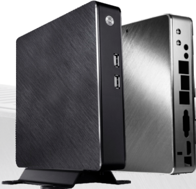
Utilização vertical com suporte fixado na base
