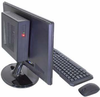
Gabinete fixado em monitor
