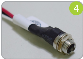
Conector de entrada para adaptador DC 12V
