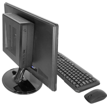
Gabinete fixado em monitor
