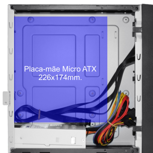
Vista interna do gabinete (sem o suporte). Fonte de alimentação instalada na horizontal para fixação de placa-mãe Micro ATX 226x174mm.
