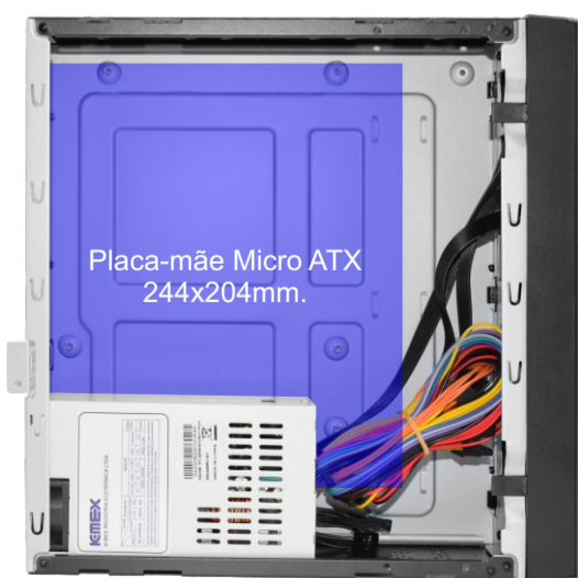
Vista interna do gabinete (sem o suporte). Fonte de alimentação instalada na vertical para fixação de placa-mãe Micro ATX 244x204mm.
