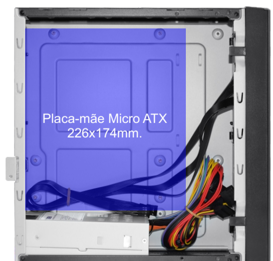
Vista interna do gabinete (sem o suporte). Fonte de alimentação instalada na horizontal para fixação de placa-mãe Micro ATX 226x174mm.
