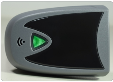
LUZ INDICADORA (verde-funcionamento; azul-bateria fraca; vermelho-carregando)
