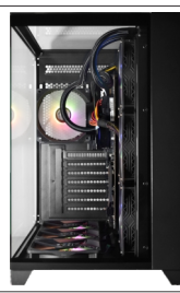
RADIADOR FIXADO EM GABINETE
