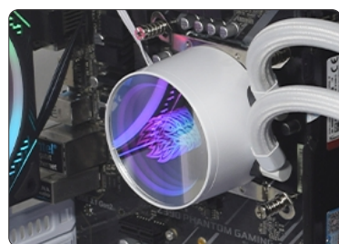
BOMBA FIXADA EM PLACA-MÃE
