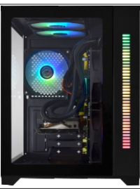
RADIADOR FIXADO EM GABINETE
