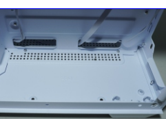
furação para fixação de 1 x 2,5" SSD
