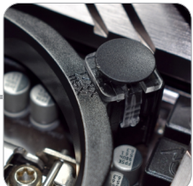
PASSO 2 (ENCAIXE SOBRE A PLACA-MÃE O SUPORTE, EM SEGUIDA ENCAIXE O PINO PRETO PRESSIONANDO ATÉ TRAVAR)
