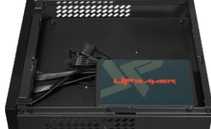
SSD DE 2.5" FIXADO NO GABINETE(NÃO INCLUSO) (PARA FIXAR É NECESSÁRIO A UTILIZAÇÃO DE 2 PARAFUSOS NA LATERAL COMO NA IMAGEM - PARAFUSOS INCLUSOS NO KIT)
