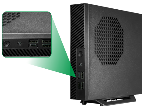
2SIUPQAHSB2XX1K (OPCIONAL) 3*USB2.0 + 1*TYPE-C (MB SIDE USB2,0),CABLE LENGTH 300MM AUDIO P3.
