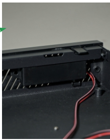
Auto Falante instalado no gabinete
