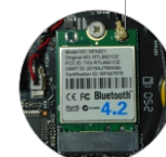
CONEXÃO SEM FIO (INCLUIDO) 1 x M2 2230 para Wi-Fi/802.11ac (Realtek RTL8821CE)
