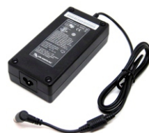
Plug 5,5mm externo (-) 2,5mm interno (+)
