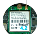
CONEXÃO SEM FIO (INCLUSO) 1 x M2 2230 para WI-FI/802.11ac (Realtek RTL8821CE)
