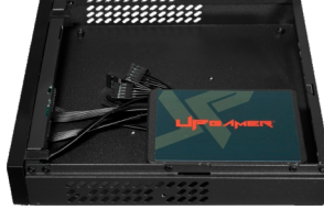
SSD DE 2.5" FIXADO NO GABINETE(NÃO INCLUSO) (PARA FIXAR É NECESSÁRIO A UTILIZAÇÃO DE 2 PARAFUSOS NA LATERAL COMO NA IMAGEM - PARAFUSOS INCLUSOS NO KIT)
