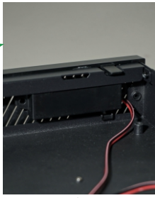
Auto falante instalado no gabinete
