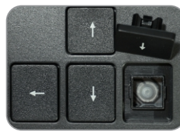
TECLAS REMOVÍVEIS TECLAS IMPRESSAS A LASER
