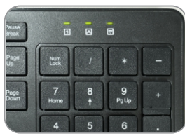
LEDs INDICADORES DE CAPS, NUM E SCROLL LOCK ATIVADOS
