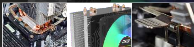
SUPOORTE FIXADO EM PLACA-MÃE
