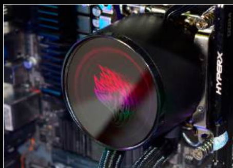
BOMBA FIXADA NA PLACA-MÃE
