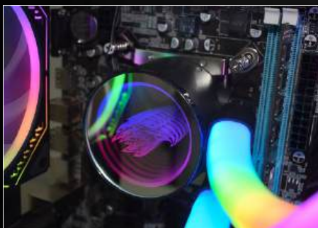
BOMBA FIXADA NA PLACA-MÃE
