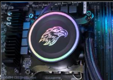
BOMBA FIXADA NA PLACA-MÃE
