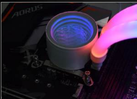
BOMBA FIXADA NA PLACA-MÃE
