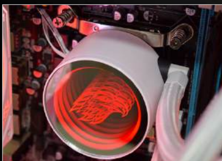
BOMBA FIXADA NA PLACA-MÃE
