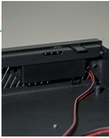
Auto falante instalado no gabinete
