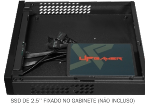
SSD DE 2.5" FIXADO NO GABINETE (NÃO INCLUIDO) (PARA FIXAR É NECESSÁRIO A UTILIZAÇÃO DE 2 PARAFUSOS NA LATERAL COMO NA IMAGEM - PARAFUSOS INCLUIDOS NO KIT)
