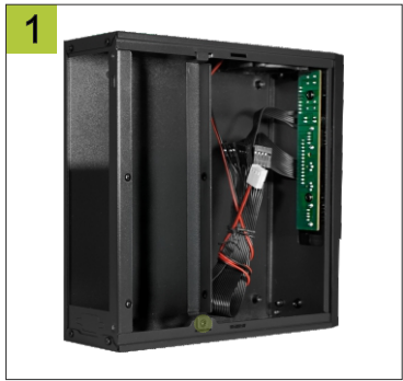
REMOVA O PARAFUSO E RETIRE O SUPORTE PARA SSD
